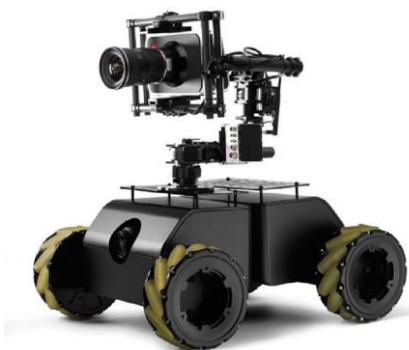
29. ábra: Példa vanora Robo "Steve" nevű földi drónjára, amelyet általában az épület belső terének szkennelésére és felmérésére, vagy az UAV-k helyettesítésére használnak a 137-es repüléstilalmi zónákban
