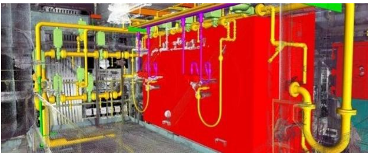
21. ábra: A LiDAR szkenneléssel pontos, beépített modelleket lehet előállítani összetett projekteknél 115
