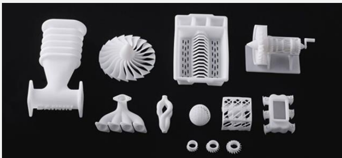
15. ábra: Példa .3D nyomtatott alkatrészekre HVAC
